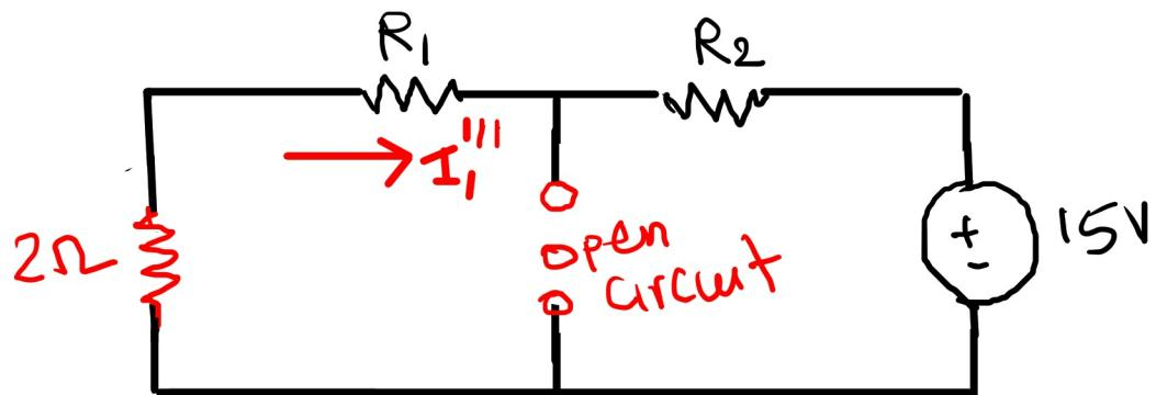
$$-2I_1''' - R_1 I_1''' - R_2 I_1''' - 15 = 0$$
