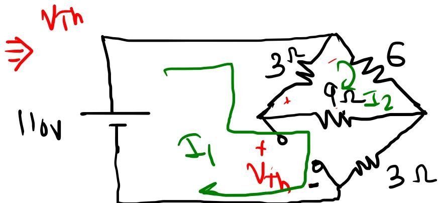
$$V_{Th} - V_{g\Omega} - V_{3\Omega} = 0$$
