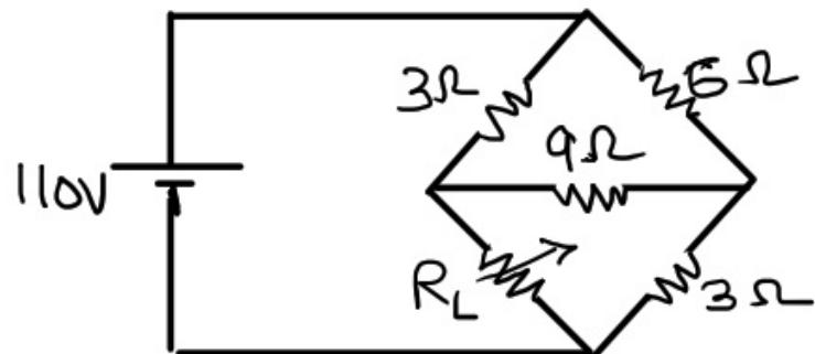
⇒ Remove  $R_L$  & find  $R_{Th}/V_{Th}$
