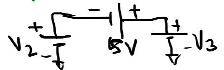
$$KVL \quad V_2 + 5 - V_3 = 0$$
